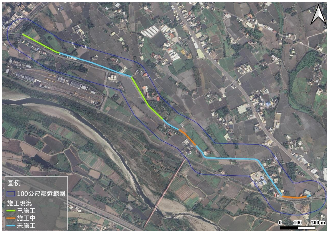
圖 2、工區不同區段施工狀態示意圖
