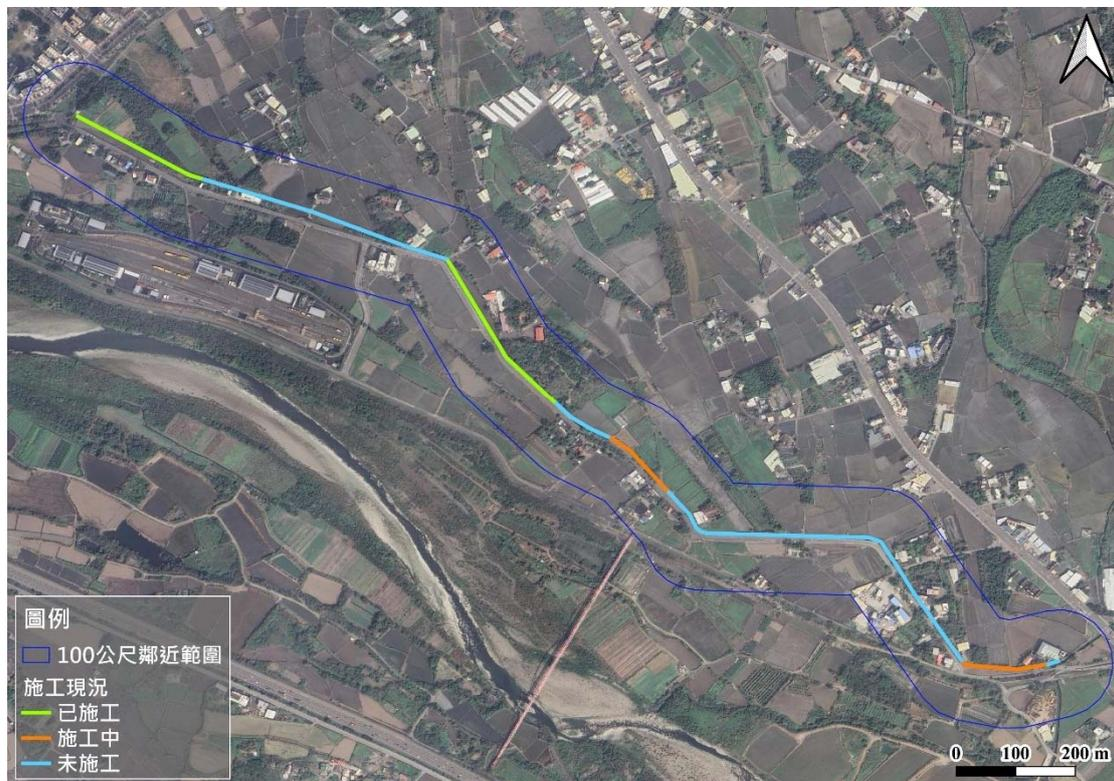
圖 2、工區不同區段施工狀態示意圖
